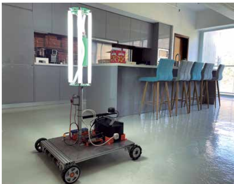
Smart autonomous UV-C disinfection robot 全自動化智能紫外光消毒機械人
